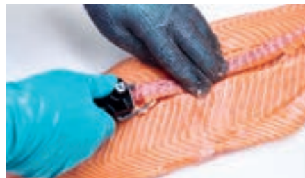
Modele Quantum Flex®: kompaktowa konstrukcja, narzędzie można prowadzić z dużą precyzją wzdłuż struktury fileta.
